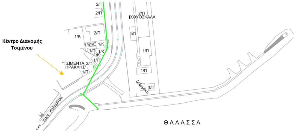
Εικόνα 1.2: Απόσπασμα Σχεδίου 3Α: «Υφιστάμενη Κατάσταση περιοχής Ιχθυόσκαλας» κλ. 1:2.000 ΣΜΠΕ Κεντρικού Λιμένα Καβάλας, Ιούνιος 2016, όπου αποτυπώνεται με πράσινη γραμμή το όριο της χερσαίας ζώνης του λιμένα Καβάλας.
